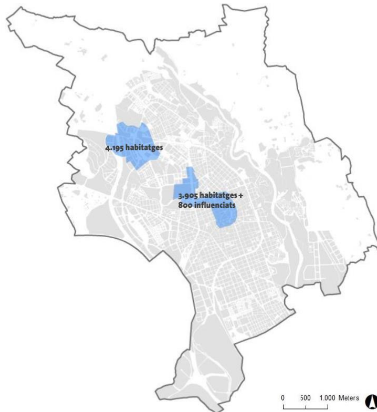
Figura 7. Distribució de la recollida amb sistema pneumàtic
