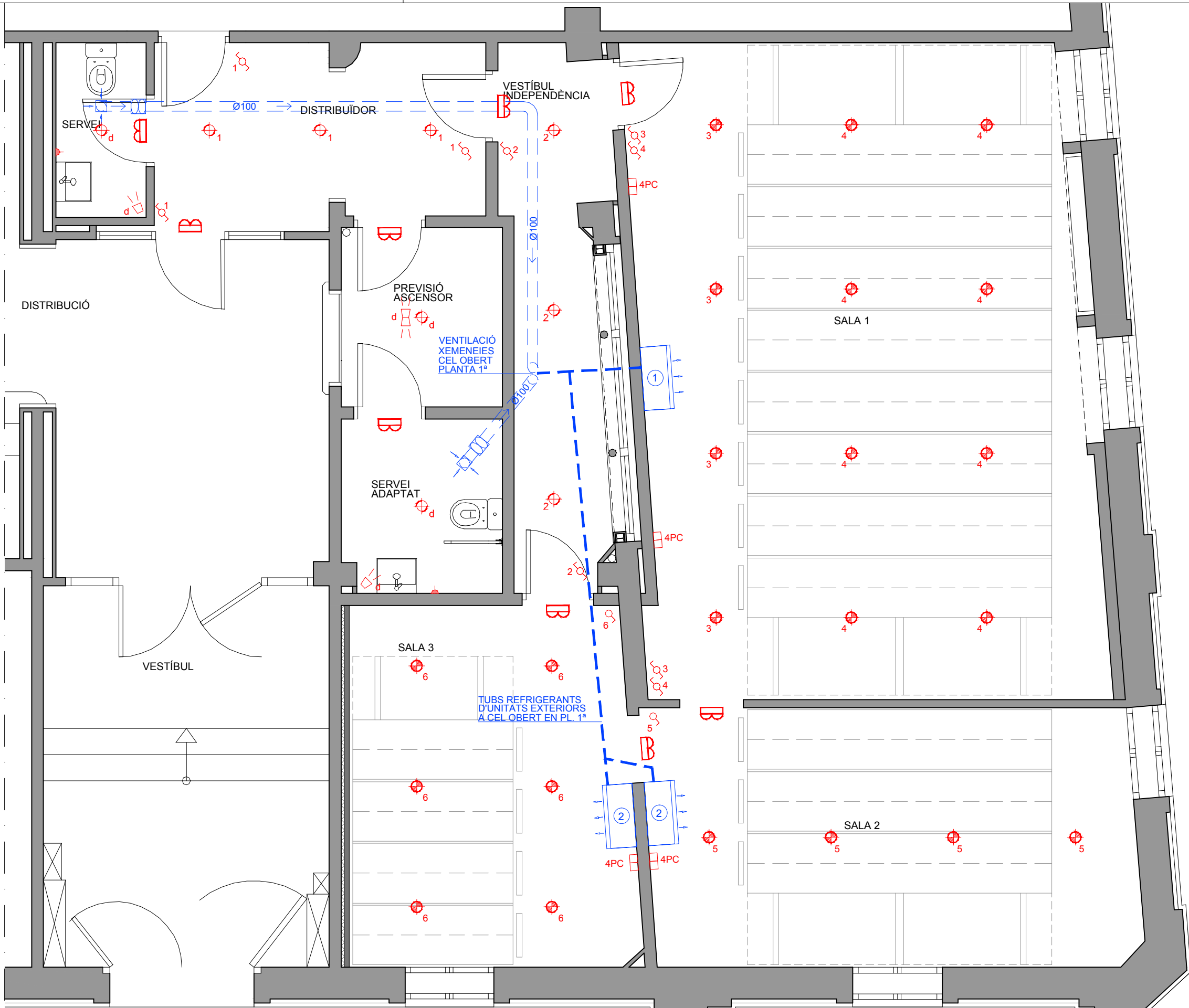
PLANTA BAIXA. INSTAL·LACIONS. ELECTRICITAT I VENTILACIÓ.
