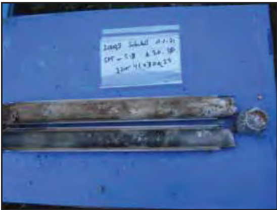
Foto 20: Sondeig S-3, SPT a 3,0 metres.
