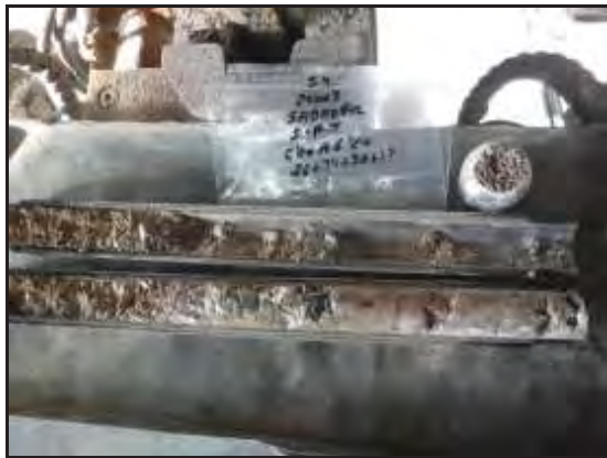
Foto 31: Sondeig S-4, SPT a 6,0 metres.
