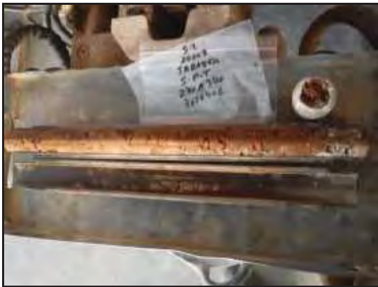
Foto 29: Sondeig S-4, SPT a 2,4 metres.
