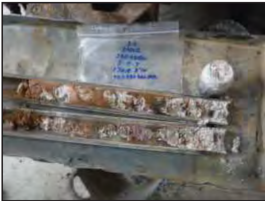
Foto 13: Sondeig S-2, SPT a 1,5 metres.
