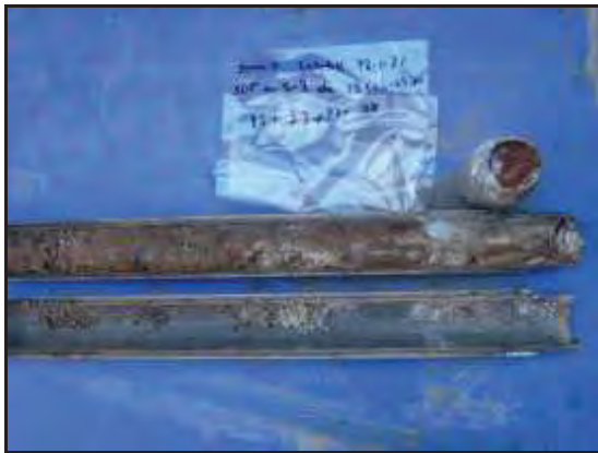
Foto 26: Sondeig S-3, SPT a 12,6 metres.
