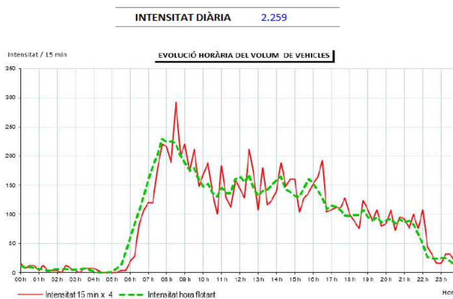
Fig. Aforament automàtic entrada Parc Taulí
