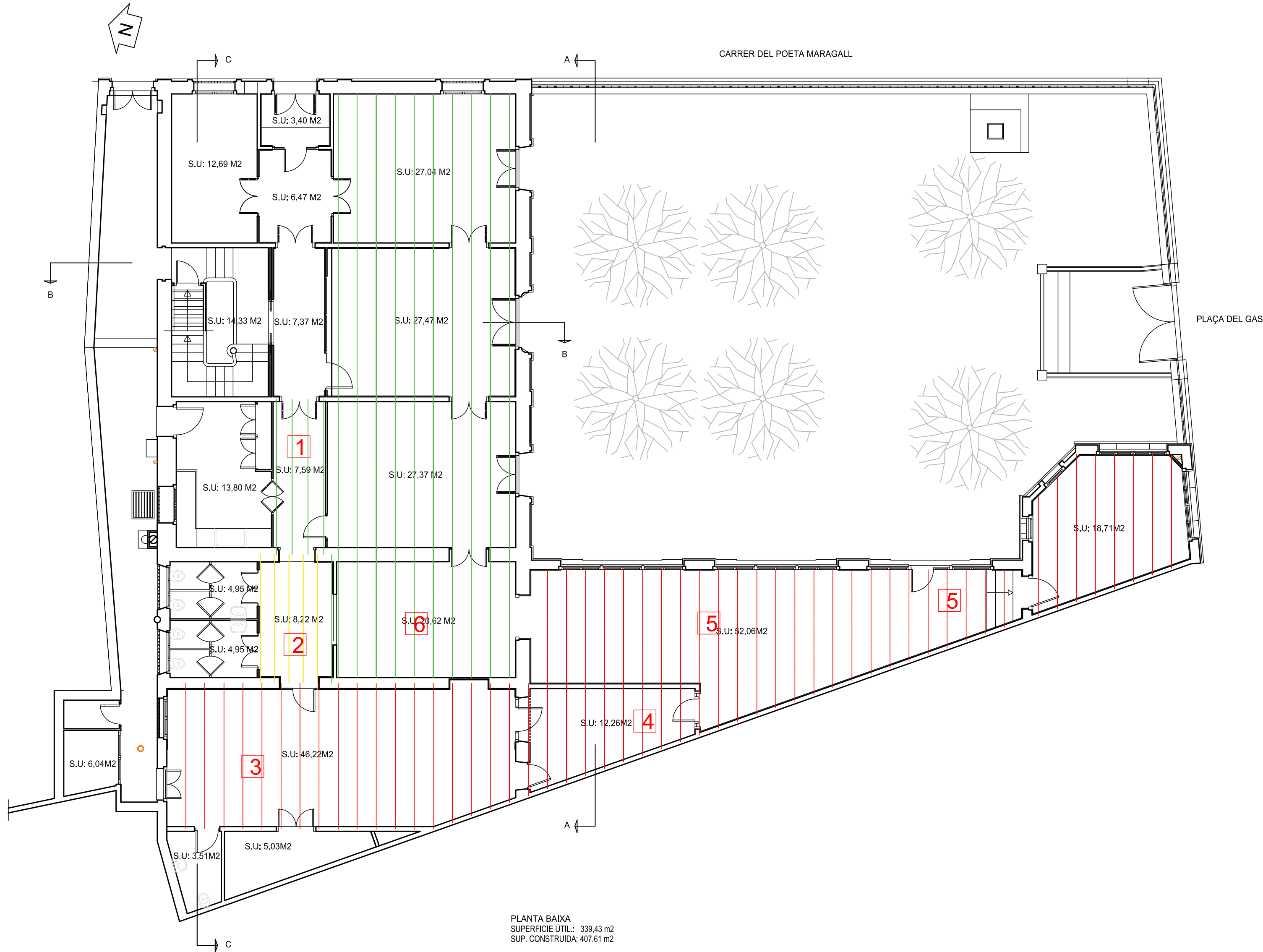
1 FORJAT BIGUES DE FUSTA SECCIÓ RECTANGULAR MURS DE CÀRREGA
