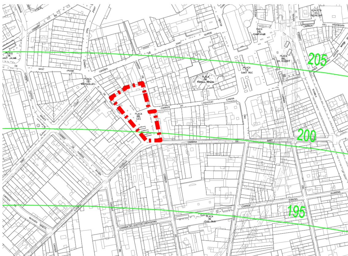
Figura 33. Còpia parcial del plànol de servituds aeronàutiques d'aeròdrom, radioelèctriques i d'operacions de l'Aeroport de Sabadell amb superposició de l'àmbit, en vermell.
