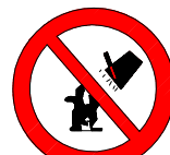
PROHIBIT APAGAR AMB AIGUA
