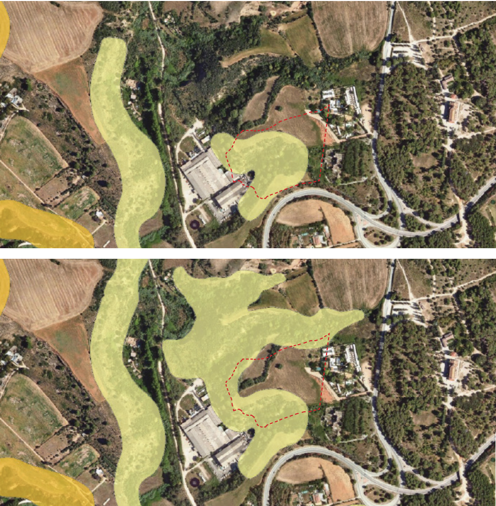
Imatges 45 i 46: Perillositat per desprendiments i per esllavissades. Font: Afectació de riscos geològics de l'ICGC
