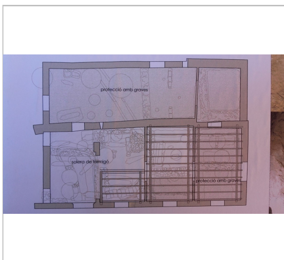
planta final rehabilitació restes arqueològiques Equip redactor
