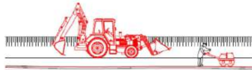
8. Reblert amb retro-excavadora de la rasa en tongades
