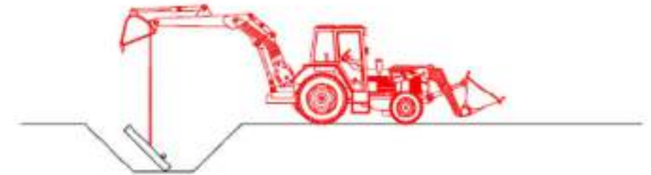
3. Col·locació de la base del pou
