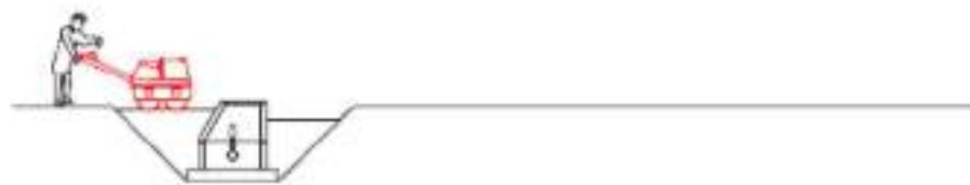
7. Compactació de terres al voltant del pou
