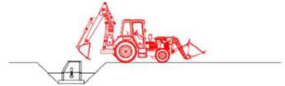
6. Reblert del pou amb retro-excavadora en tongades
